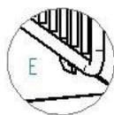
após realizado o movimento apoie a grelha sobre os pinos de apoio. A mesma devera ficar conforme a imagem ao lado.
